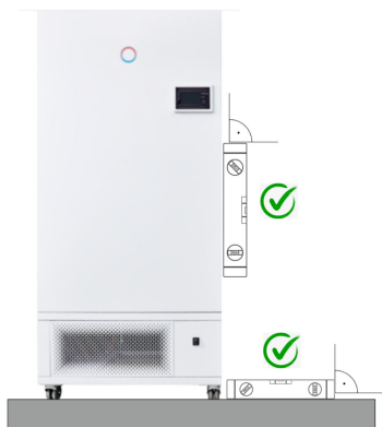
Fig. 2 : Mise en place de l'armoire
